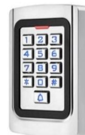
E-50 ~ Autonomais WiFi kontrolieris ar EM 125KHz nolasītāju un šifratoru 2000 lietotāji 12v IP68
